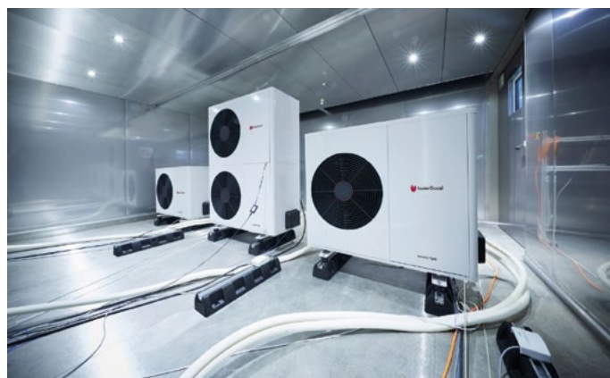
Komory klimatyczne symulują wszystkie potencjalne warunki eksploatacji
